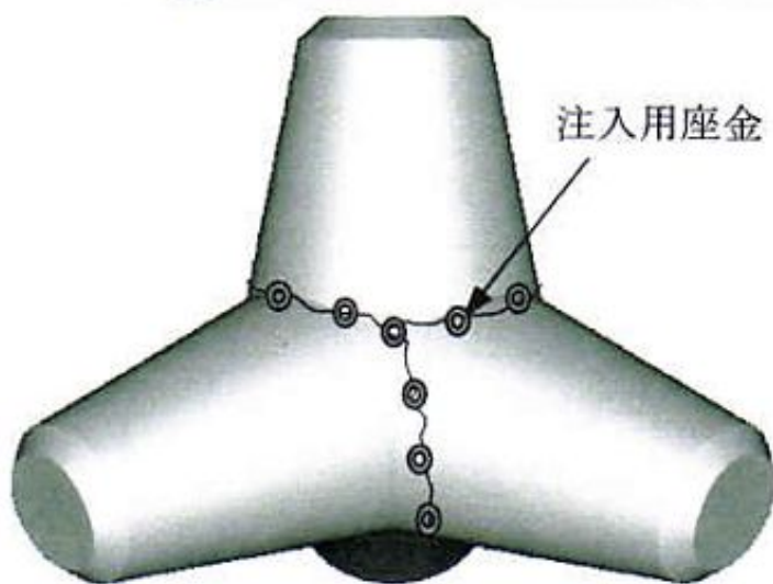
注入用台座取付
